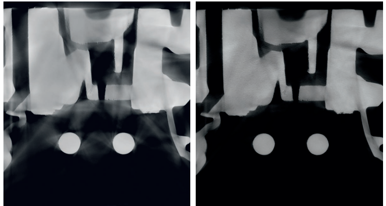
Verbesserung der Bildqualität: Kegelstrahl-CT ohne (links) und mit ScatterFix 2.0 (rechts).
